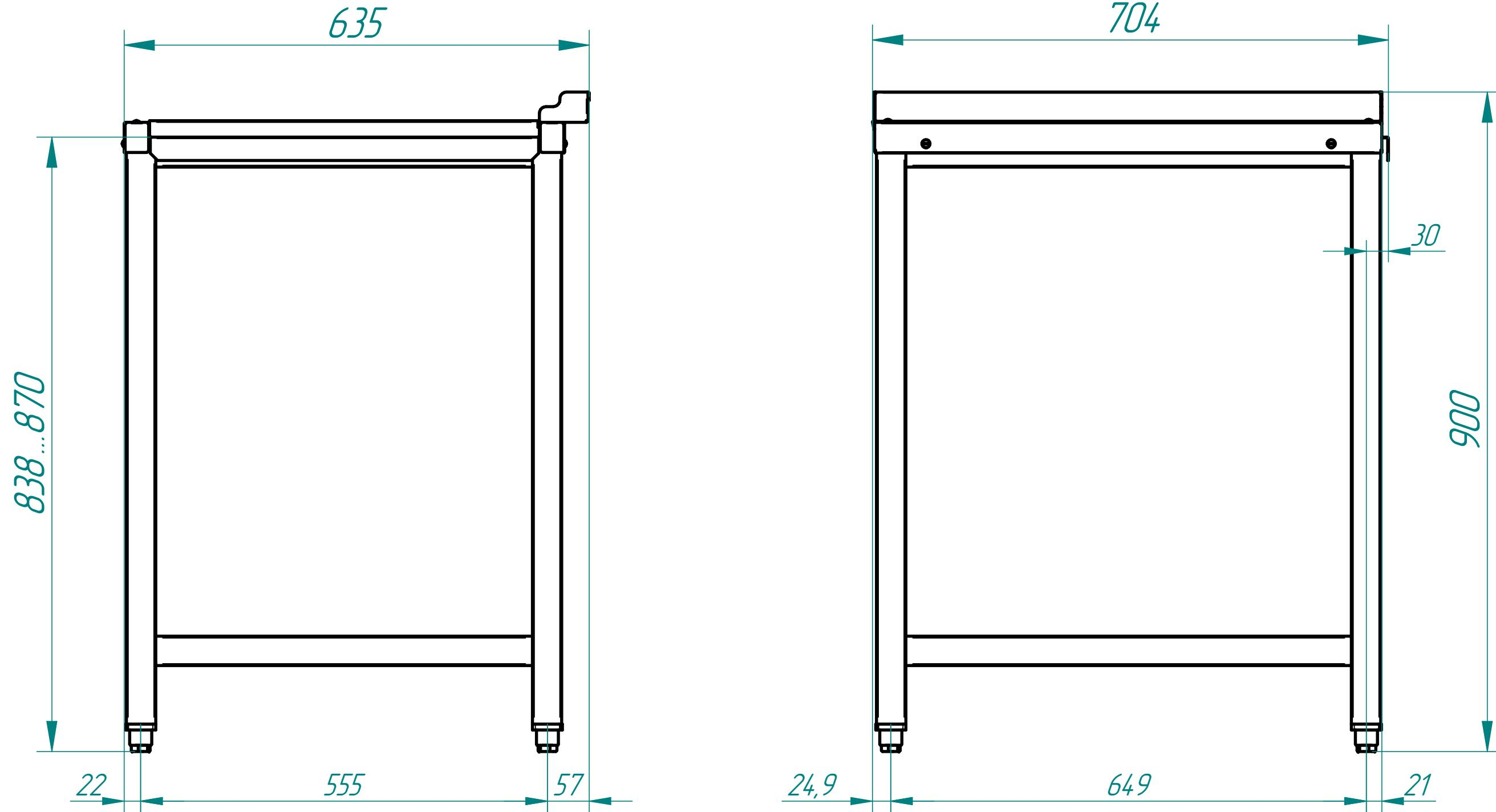
Стол раздаточный используется в комплексе с посудомоечной машиной, имеет регулируемые по высоте ножки (не менее 20 мм). Стол полностью разборный с обвязкой по четырем сторонам, изготовлен полностью из высококачественной нержавеющей стали. Путем несложного монтажа стол можно установить как в правом, так и в левом исполнении.
