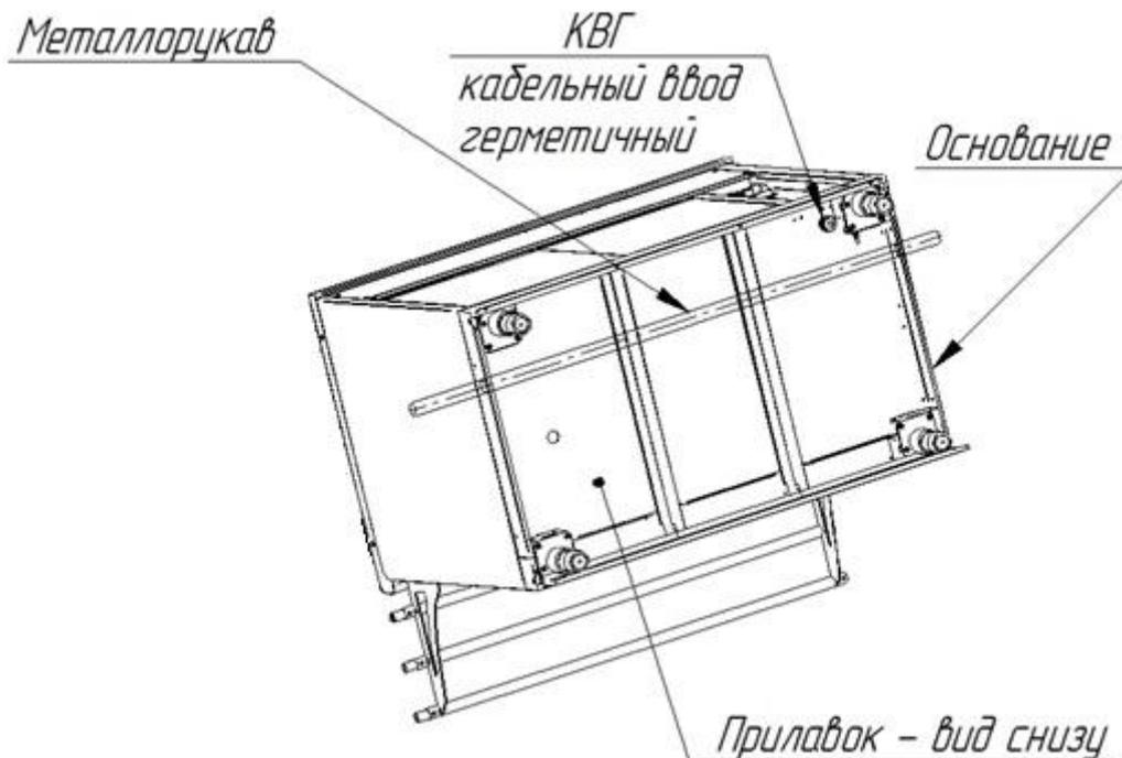
В основаниях изделий линии раздачи введено сквозное отверстие диаметром 29,5 мм для возможности проведения металлорукава с питающими кабелями сквозь все изделия линии раздачи.
